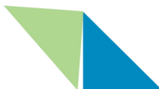
Figura III.10 – Esempio di bad-edge che mostra due triangoli vicini che però non condividono ogni punto lungo il lato.
