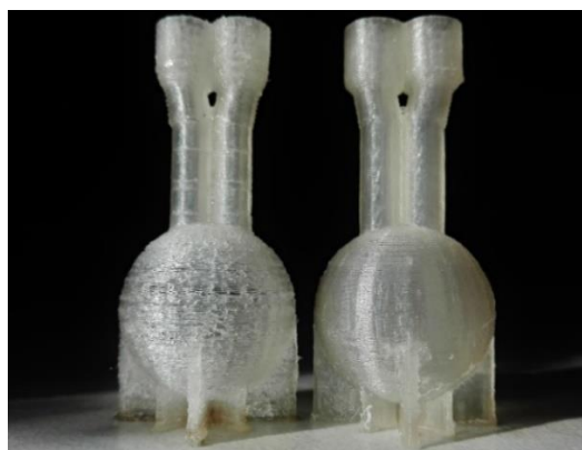
Figura IV.11 - La prima ampolla è il risultato della prima prova di stampa (v.max e MLT a 1 sec), la seconda è il risultato della seconda prova (v.max e MLT a 5 sec).
