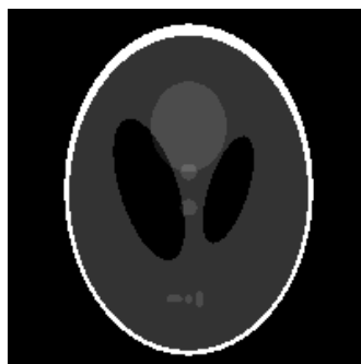
Figura II.2 - Fantoccio di Shepp-Logan, costituito da 10 regioni uniformi ma di ampiezza diversa, racchiuse da altrettanti ellissi di opportune dimensioni e orientazione per rappresentare una sezione del cranio umano. Il fantoccio si presta bene per la valutazione dell'accuratezza delle differenti tecniche di ricostruzione tomografica.
