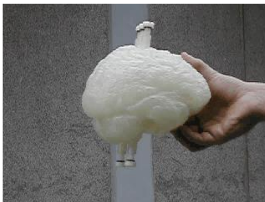
Figura II.14 - Il fantoccio fisico completo realizzato mediante stereolitografia.
