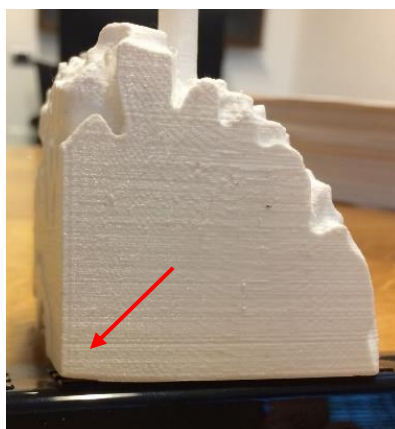
Figura IV.2 – Porzione del fantoccio cerebrale stampata in PETG in cui è visibile il warping sull'angolo della base indicato dalla freccia.
